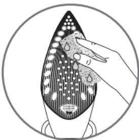
\*FR Nettoyage de la semelle • KO 열판 세척하기 • TH การทำความสะอาดแผ่นหน้าเตารีด • AR پاک کردن کف اتو • FA تقطیف نعل المکواة • HK 清潔底板 • RC 清洁底板 • EL Καθαρισμός της πλάκας
